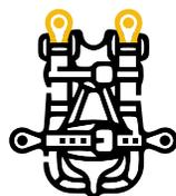
Anillos D para los hombros: este par de anillos D, que normalmente se encuentran en la parte superior de los hombros del usuario, se utilizan junto con una barra separadora para facilitar la entrada y/o el rescate en espacios confinados, de modo que el cuerpo del usuario permanezca erguido.
