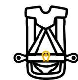
Anillo D posterior para la cintura: normalmente se encuentra en un cinturón en la base de la columna vertebral del usuario o junto a ella. Este anillo D está diseñado para usarse únicamente en aplicaciones de restricción.
