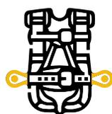
Anillos D laterales: ubicados en las caderas del usuario o directamente adyacentes a ellas, este par de anillos D están diseñados para soportar el peso del usuario mientras realiza trabajos de posicionamiento.
