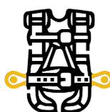
Anillos D laterales: ubicados en las caderas del usuario o directamente adyacentes a ellas, este par de anillos D están diseñados para soportar el peso del usuario mientras realiza trabajos de posicionamiento.
