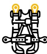
Anillos D para los hombros: este par de anillos D, que normalmente se encuentran en la parte superior de los hombros del usuario, se utilizan junto con una barra separadora para facilitar la entrada y/o el rescate en espacios confinados, de modo que el cuerpo del usuario permanezca erguido.
